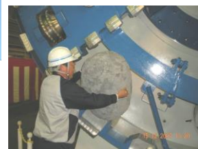
切刀盤開口率>50%，長70cm寬60cm以下之卵礫石可直接進入土倉內
