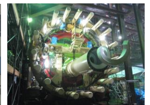
螺運機: 無中軸 彩帶型 (搬出最大礫徑 708x930mm)
